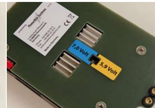
Auf der Unterseite befinden sich die beiden Mikroschalter zur Einstellung der Servo-Versorgungsspannung
