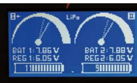
Beide Empfänger funktionieren einwandfrei. Die Signale von RX I werden verwendet. Der gestrichelte Schleppezeiger zeigt den Spannungsabfall aufgrund des Akkutests
