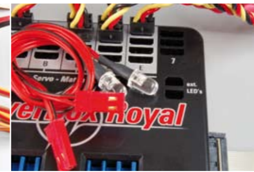
Hier können zwei superhelle LEDs zur Überwachung der Akkus angeschlossen werden
