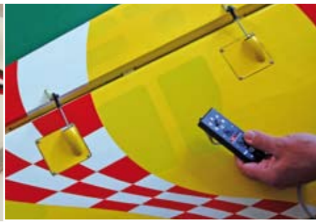
Mit dem Einstellboard lassen sich zum Beispiel mehrere Servos, die auf ein Ruder wirken, einjustieren
