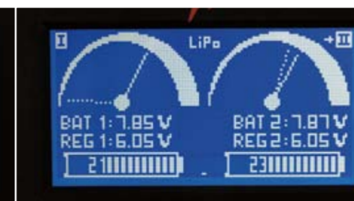
Akku I hatte irgendwann kurzzeitig einen kompletten Spannungsabfall, möglicherweise durch einen Kabelbruch ...
