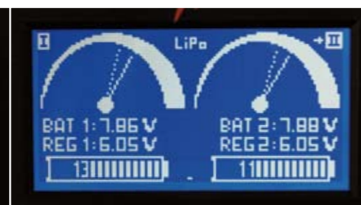
Obwohl Empfänger I wieder verwertbare Servosignale ausgibt, bleibt II weiterhin aufgeschaltet
