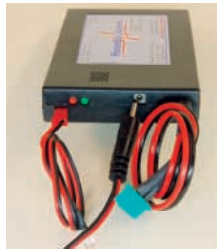
Von links: LED-Anschluss für low-voltage, LEDs für Ladezustand, Ladebuchse mit Stecker, Anschlusskabel
