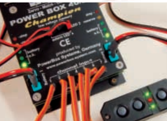
Die Multiplex-Hochstromstecker werden durch Haltenasen sicher gehalten
