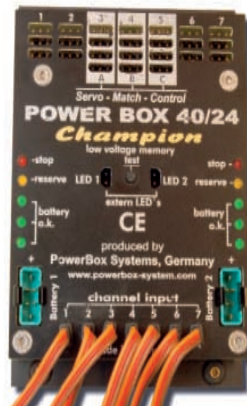
24 Servosteckplätze stehen zur Verfügung, davon zwölf mit Servo-Match-Control Funktion
