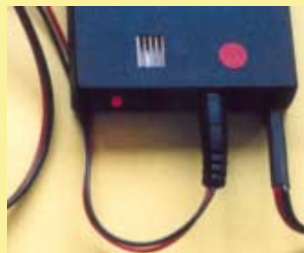
Die beiden Akkus mit dem zugehörigen Netzgerät zum Laden (Bild rechte Seite oben). Neben dem roten Punkt erkennt man auf dem Akkugehäuse den Kühlkörper (silbern) für die Ladeelektronik. Ist der Akku am Netzteil angeschlossen, zeigt die rote LED neben dem Ladestecker, dass der Ladevorgang läuft (Bild oben).
