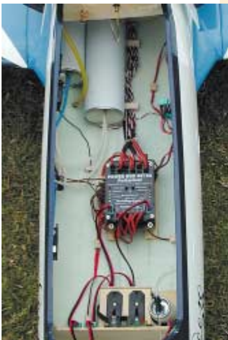
Der 20-A-Schalter mit grüner LED und Ladebuchse.
