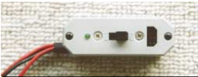
Der 20-A-Schalter mit grüner LED und Ladebuchse.
